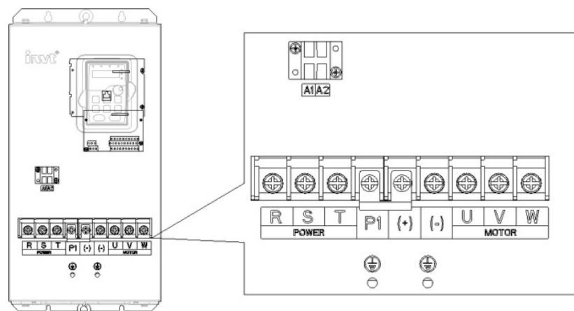
Рис. 5-9 Клеммы силовых цепей 37 – 55 кВт
