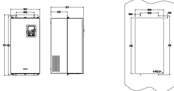
Рис. 4.11 Фланцевый монтаж 37 – 110 кВт
