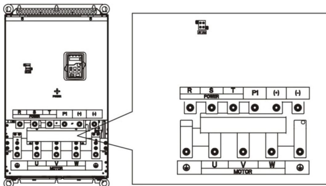
Рис. 5-11 Клеммы силовых цепей 132 – 200 кВт
