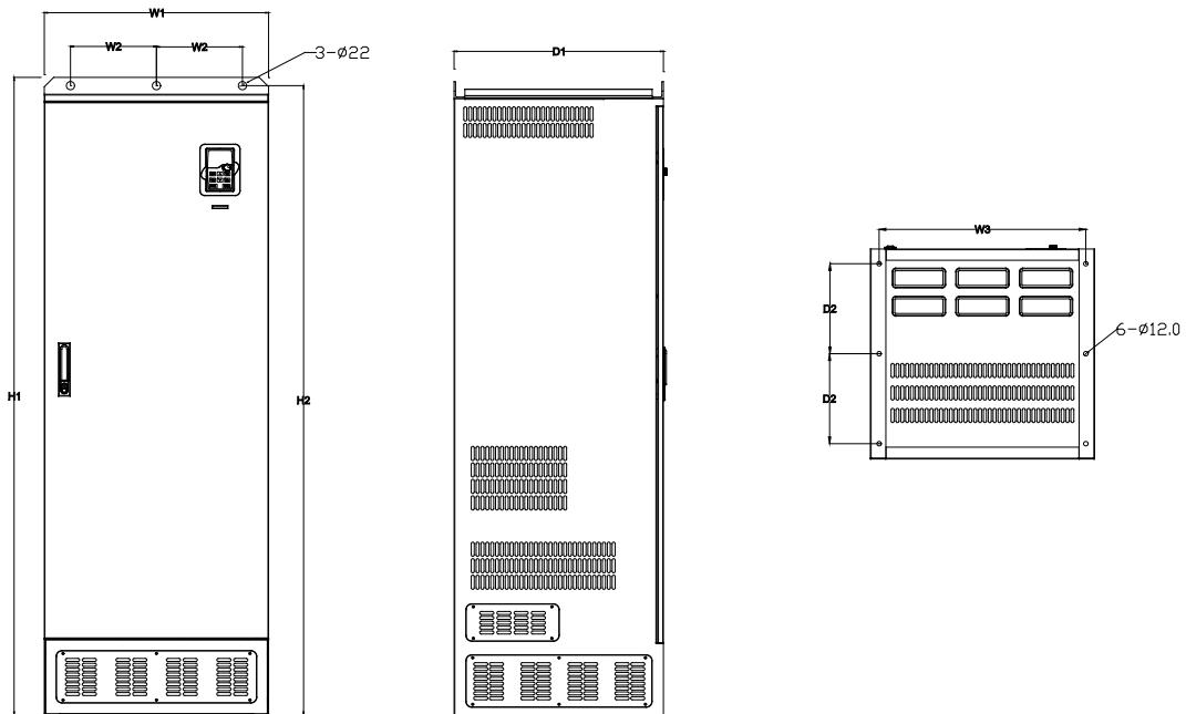
Рис. 4.14 Напольный монтаж 350 – 500 кВт
