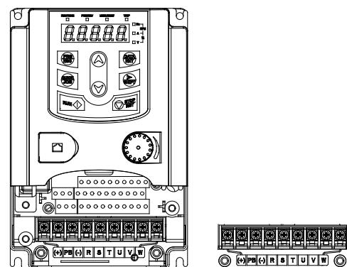
Рис. 5-4 Клеммы силовых цепей 0.75 – 2.2 кВт
