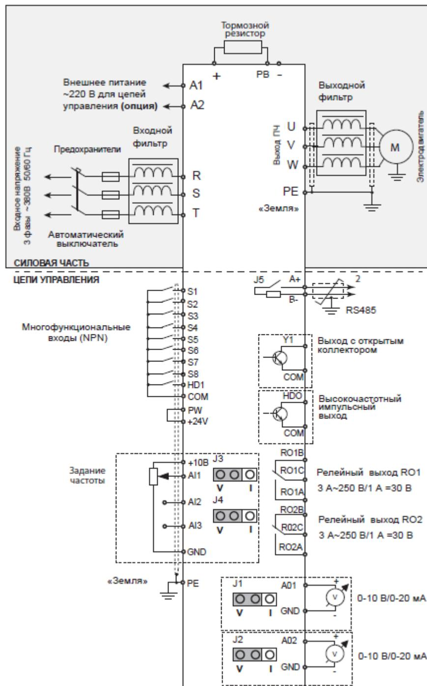
Рис. 5-3.1. Подключение основных цепей ПЧ < 37 кВт
