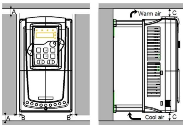
Рисунок 4-16. Вентиляционные промежутки
