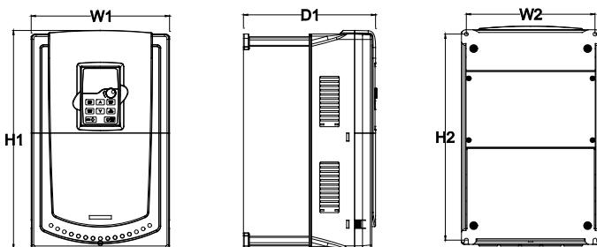
Рис. 4.6 Настенный монтаж 1.5 – 30 кВт
