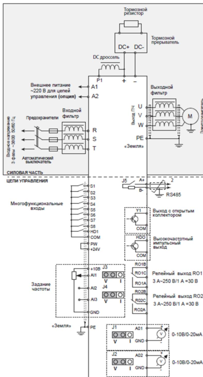
Рис. 5-3.2. Подключение основных цепей ПЧ > 37 кВт
