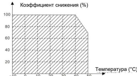
Рисунок 3-2. Снижение номинальной мощности ПЧ.
