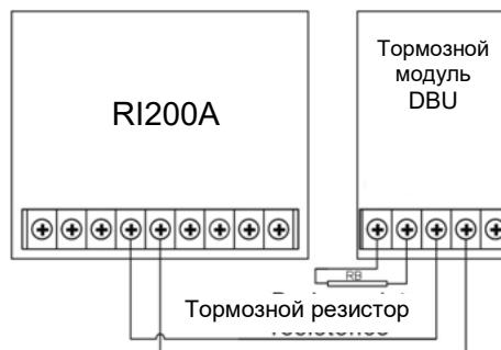
Рис. 12-3. Схема подключения модуля DBU и тормозного резистора
