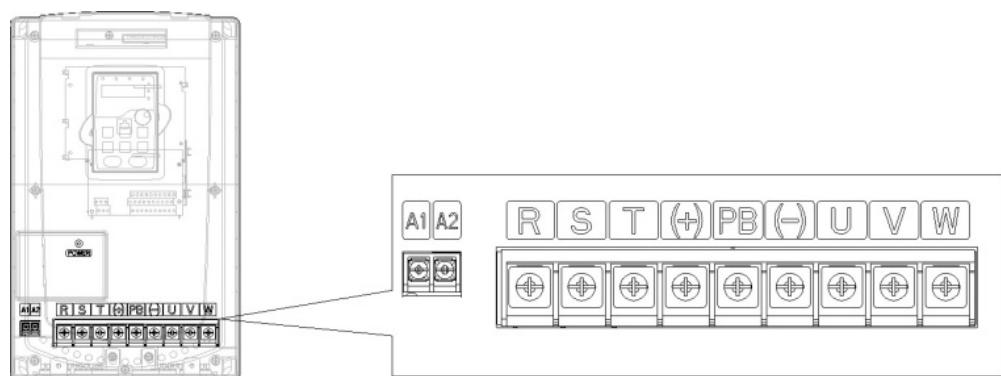
Рис. 5-8 Клеммы силовых цепей 22 – 30 кВт
