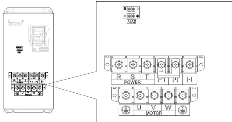
Рис. 5-10 Клеммы силовых цепей 75 – 110 кВт
