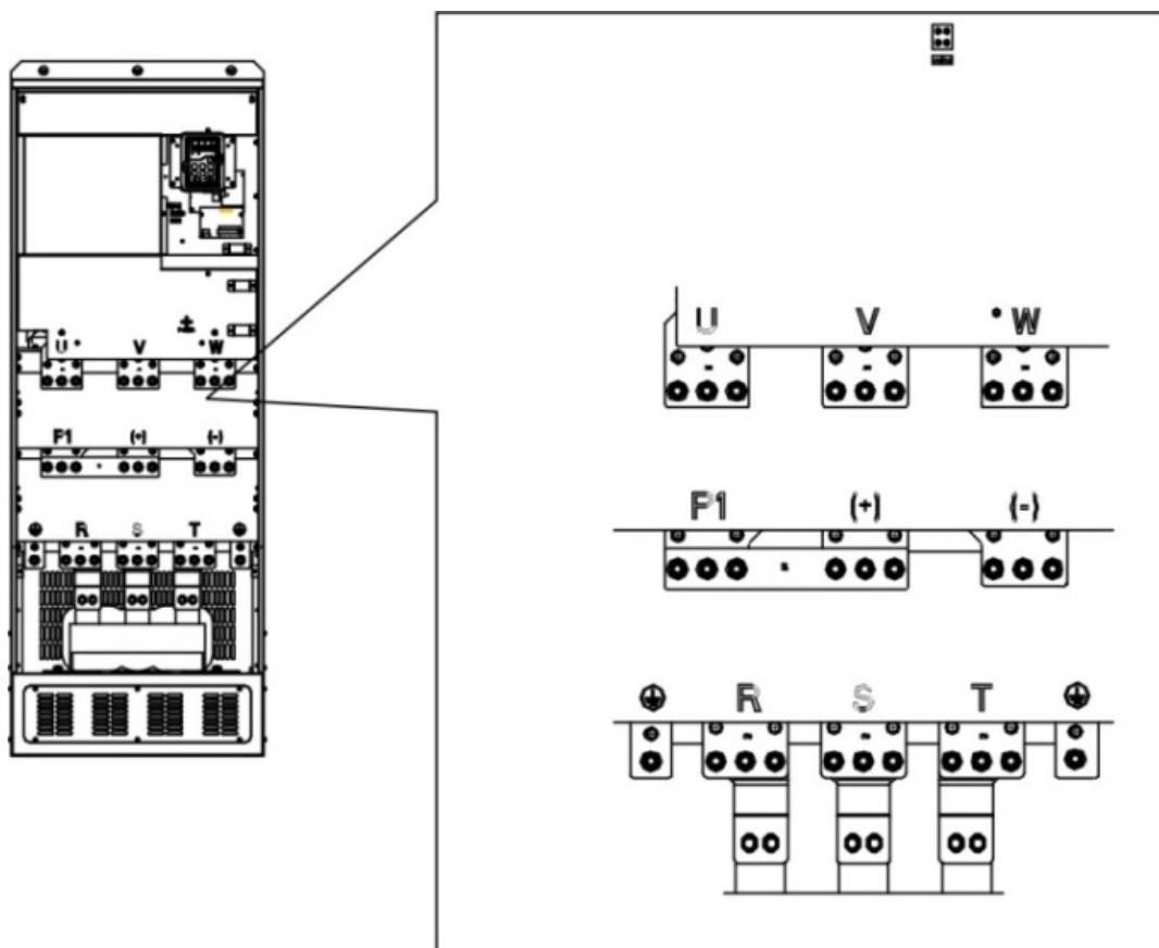
Рис. 5-13 Клеммы силовых цепей 350 – 500 кВт
