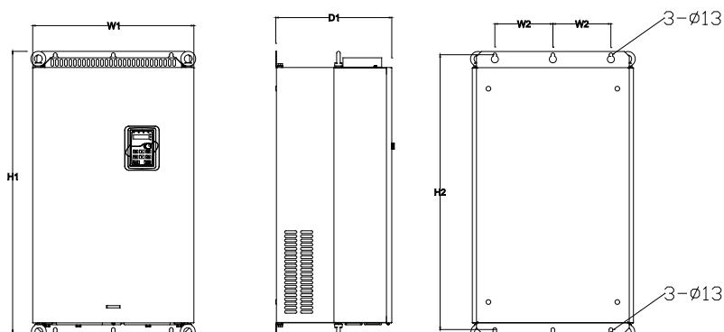
Рис. 4.8 Настенный монтаж 132 – 200 кВт
