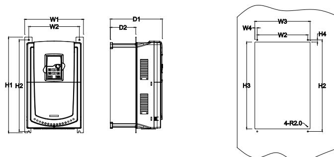
Рис. 4.10 Фланцевый монтаж 1.5 – 30 кВт
