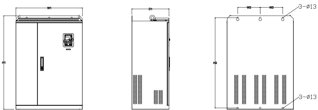
Рис. 4.9 Настенный монтаж 220 – 315 кВт
