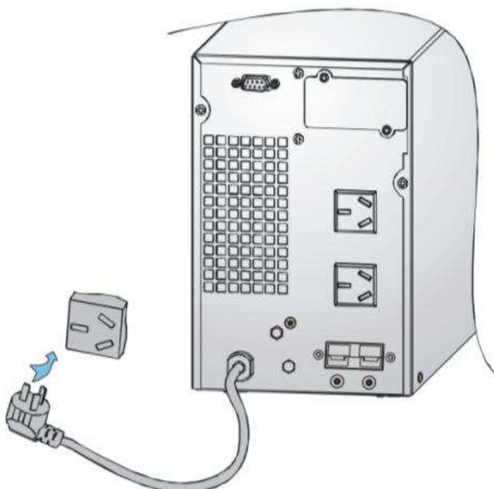
Рисунок 3.1 - Способ подключения входного кабеля
